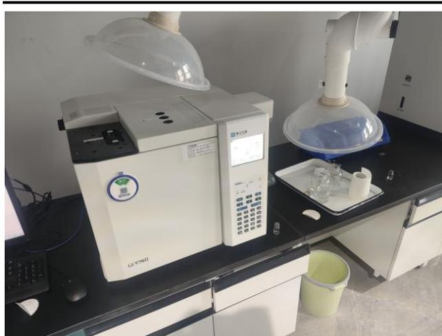
废气收集 (万向排气罩)
